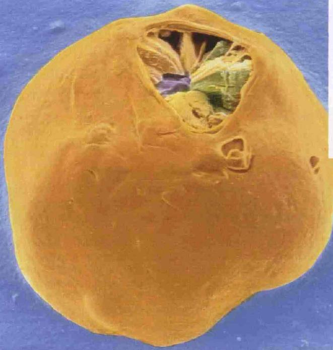
» **Buon appetito, batteri.** Un granulo di plastica biodegradabile ingrandito 4 mila volte. Quando assorbe acqua si espande e si sbriciola in frammenti minutissimi, digeribili dai batteri.
